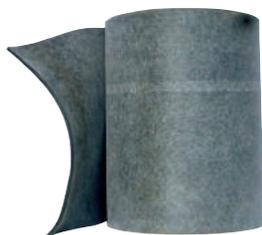
Membrana impermeabilizzante non armata a base di bitume e polimeri elastomerici in rotoli o in bande. La superficie è in film di non tessuto termofusibile. Utilizzata per l'impermeabilizzazione dei giunti di dilatazione o dove sono previsti movimenti limitati (<20mm). La membrana X-JOINT va impiegata sotto protezione pesante e opportuna-
