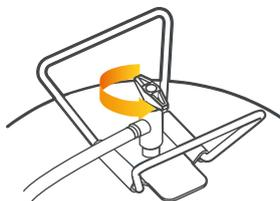
**1.** Quando non viene utilizzata, la valvola sulla bombola deve rimanere aperta fino allo svuotamento della bombola, con la pistola a spruzzo innestata e spenta. Se la valvola rimane chiusa, l'adesivo può otturare e bloccare il tubo.
