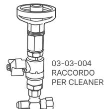
**3.** Se si prevede di non utilizzare il sistema per un periodo di tempo significativo, il tubo e l'erogatore dovrebbero essere completamente puliti con Supra Cleaner adottando l'apposita valvola da innestare sul canister.
